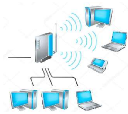
Figura 6.1 Infraestructura básica Wi-Fi.
